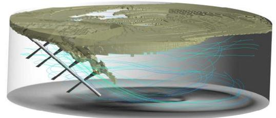
Untersuchung und Optimierung der Strömungen und der Wirkung des Rührwerkes zur Durchmischung und Auflösung der Sink- und Schwimmschichten CFD Simulation
